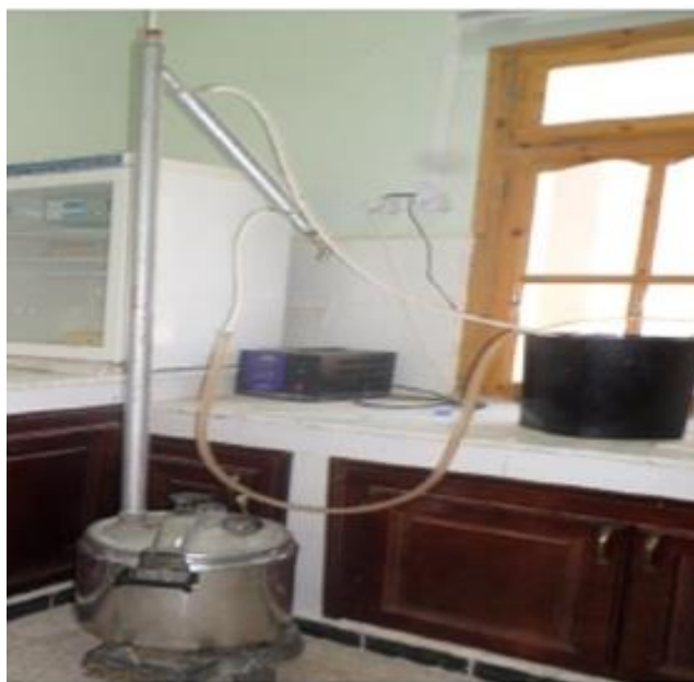
Fig. 1. Montage d'extraction type Hydrodistillation.
