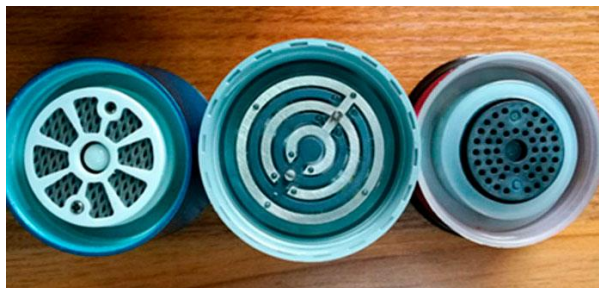
Fig. 2. Système sans membrane échangeuse de protons SPE/PEM
