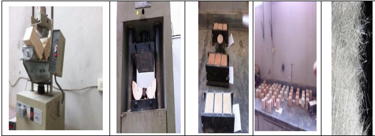
الشكل (3): عينات المونة المحضرة في المخبر والألياف الزجاجية المستخدمة
