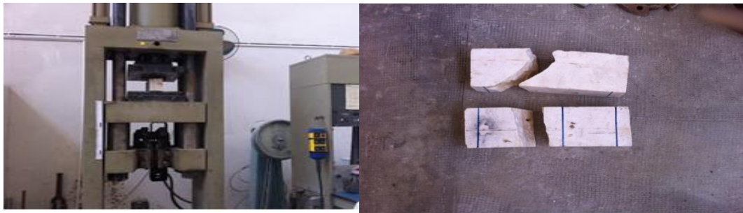
الشكل (7) عينة الحجر أثناء الاختبار على الشد
