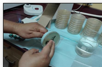
12- Mise en contact avec la boîte de gélose nutritive boîte correspondant   10 minutes de d contamination
