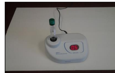
6- Suspension de 0.5 Mc Farland correspondant à 10^8 UFC/ml, mesurée au densitomètre
