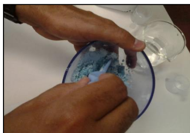
1- Malaxage manuel de la poudre et de l'eau Pendant 30 secondes à température ambiante (23°C)
