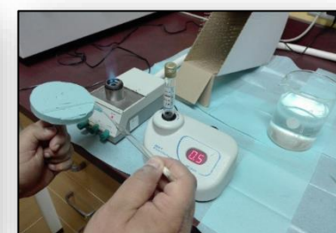
8- Etalement au râtelier de la quantité déposée de la suspension (Pour une répartition homogène des bactéries à la surface de l'empreinte)
