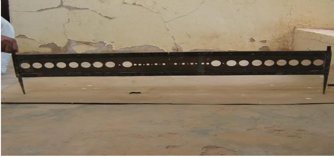
الصورة(2): تمثل آلة قياس الماء المعروفة بالشقفة أو الحلافة المصدر: الإذاعة الجزائرية على الرابط التالي:
