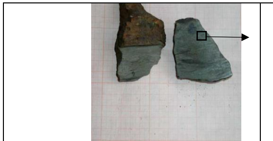
الشكل 5: مظهر بعض عينات خام الحديد السيليكاتي (SO)
