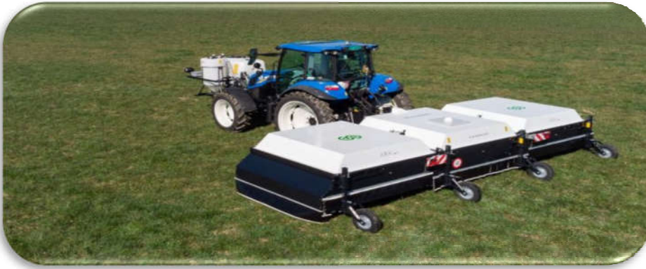
الشكل 04: روبوت الرش الذكي ARA
