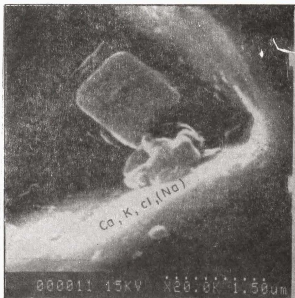
2. Cavité d'inclusion fluide contenant des cristaux de sels de composition Ca, K, Cl, (Na) (Photo M.E.B.)
