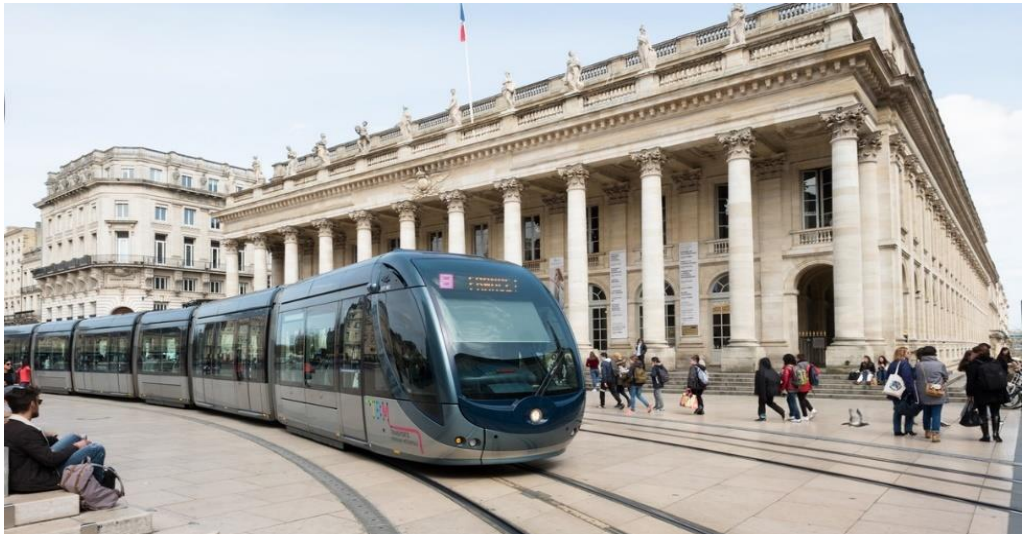
Figure 6 : Le tramway de Bordeaux, l'un des seuls au monde à être alimenté par le sol
