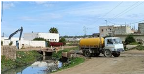
Fig.5. Camion de vidange des fosses septiques
