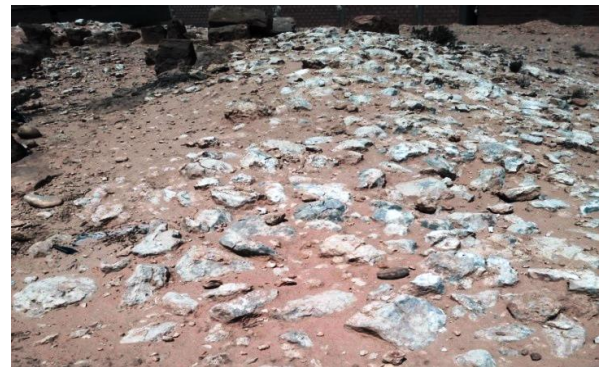
الصورة 01: تمثل الحجارة الدبشية المستخدمة في بناء جدران الحصن بالتقنية الإفريقية، عن: عريج، نجم الدين، ديسمبر 2021م.
