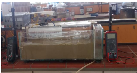
Fig. 1 : Cellule du traitement électrocinétique
