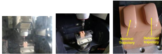
Figure 11: Usinage sur une machine 5 axes Ultrasonique
