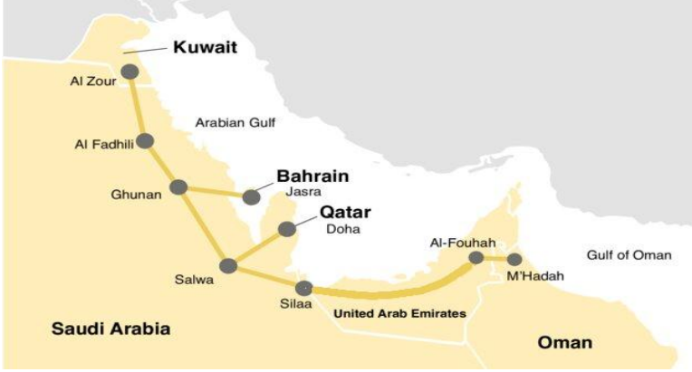
الشكل 2: شبكة الربط الكهربائي بين دول مجلس التعاون الخليجي
