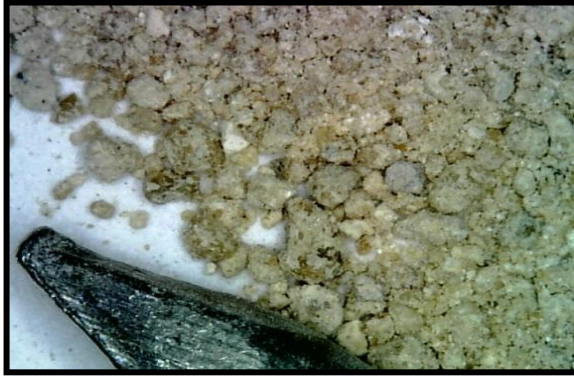
صورة رقم 02: صورة لتحليل عينة من الملاط لمنشأة المنصورة عن طريق المكبر الإلكتروني
