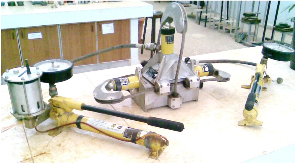
الشكل (3): جهاز هوك لقص الصخور في مخبر جامعة البعث – حمص (2014)
