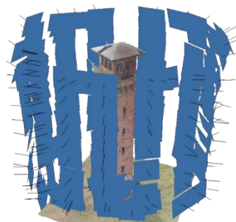
شكل 07: تموضع الطائرة بدون طيار بالون الأزرق لالتقاط صور بزوايا مختلفة لبرج طول (Molnar Andras, 2018, p. 254)
