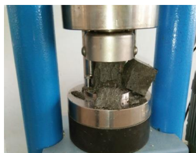
Fig. 6 – Essai de résistance à la compression des mortiers.
