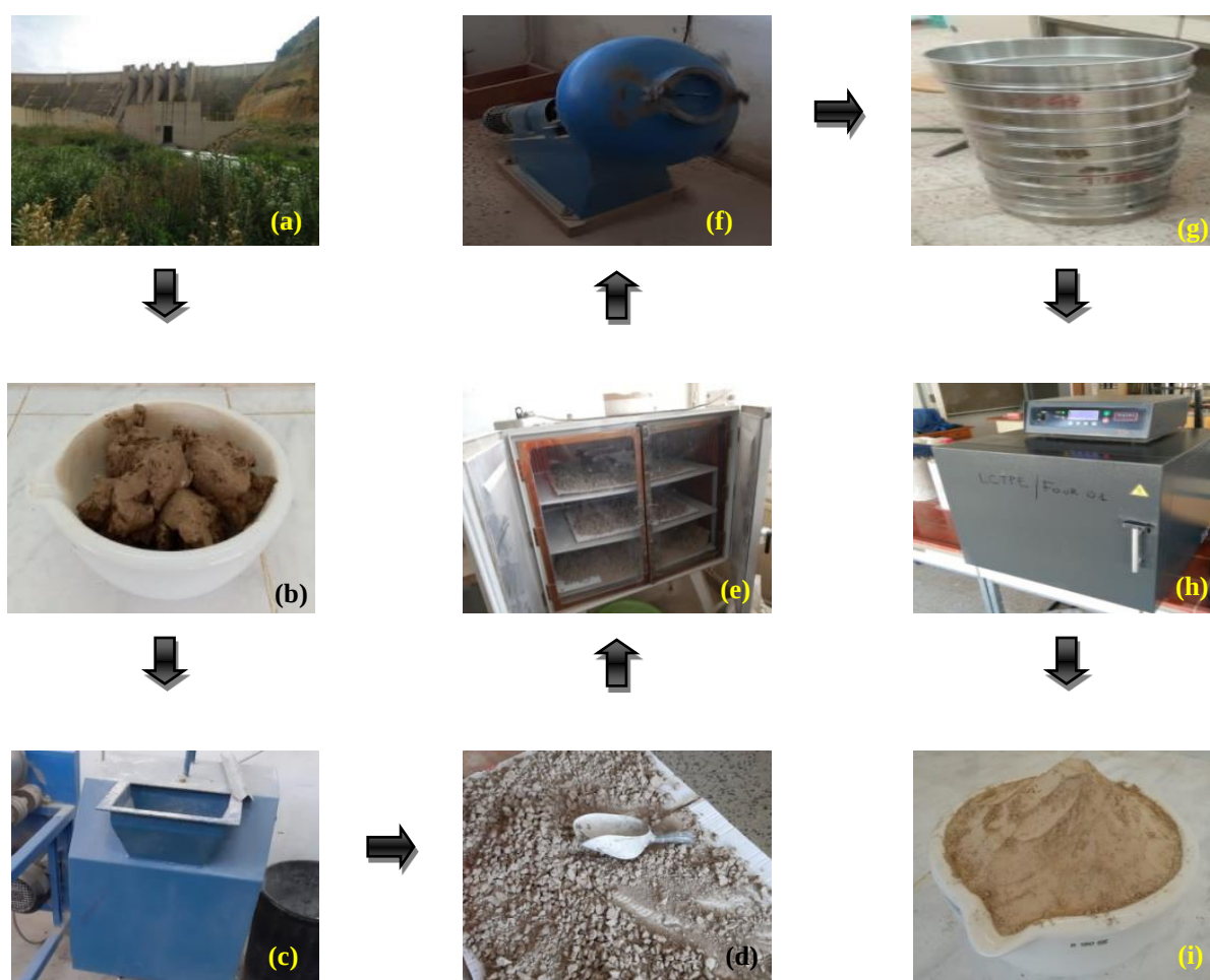
Fig. 1 – Etapes de préparation de la vase calcinée de barrage Chorfa (a) Extraction, (b) La vase à l'état humide (c,d) Calibrage 25mm, (e) Etuve à 40°C, (f) Broyage, (g) Tamisage 63 µm, (h) Traitement thermique 750°C pendant 5 heures, (i) Vase calcinée prête à utiliser.
