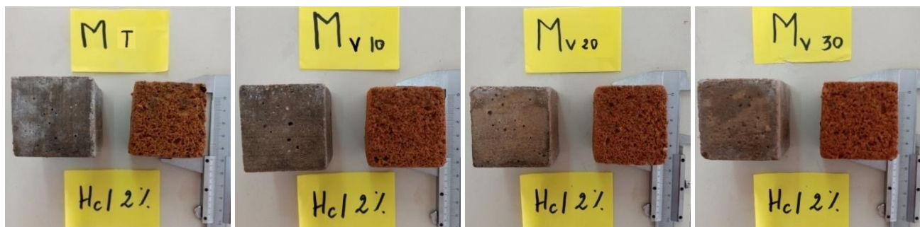
Fig. 12 – Mortiers MT, MV10, MV20 et MV30 après 15 semaines d'immersion en solution HCl 2%.
