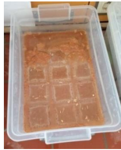
Fig. 7 – Immersion des éprouvettes dans la solution acide.
