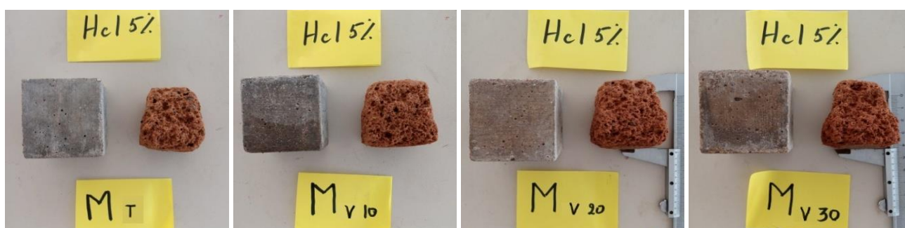
Fig. 14 – Mortiers MT, MV10, MV20 et MV30 après 15 semaines d'immersion en solution HCl 5%
