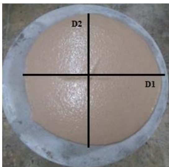
Fig. 2 – Consistance du mortier frais.
