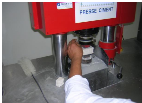
Fig. 4 - Essai mécanique sur mortiers.
