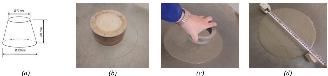
Fig. 4 - (a) Schéma du cône d'étalement ; (b) à (d) Essai d'étalement du mortier au cône d'étalement
