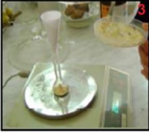
إضافة المسحوق داخل البيكنومتر
