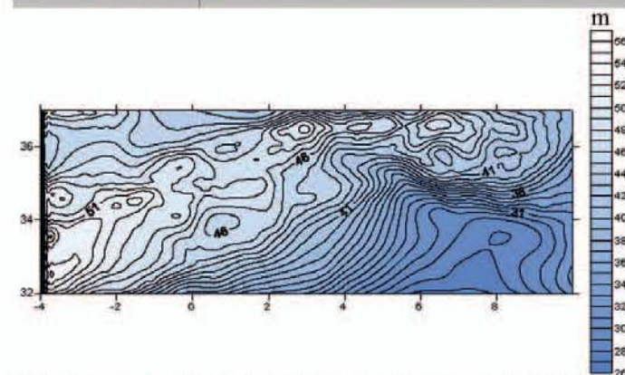
Fig. 6: Quasi-géoïde adapté par rapport au GPS/Nivellement.
