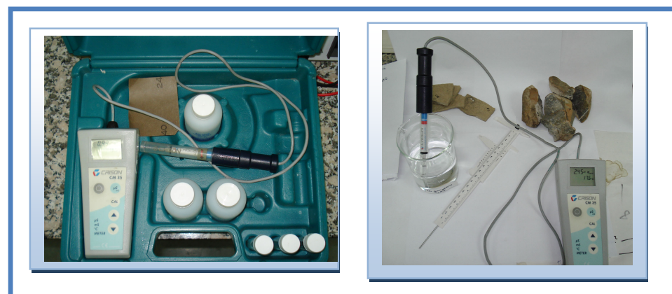
Figure3 :Mesure des conductances à l'aide d'un conductimètre
