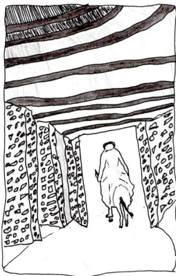
الصورة 4، الشكل 5: الطريقة الثانية لبناء الساباط من أحد قصور تميمون .
