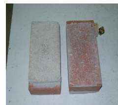
Figure 4. Rupture due à l'essai de cisaillement sur le couplet [10,11]
