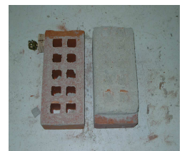
Figure 4. Rupture due à l'essai de cisaillement sur le couplet [10,11]
