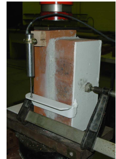
Figure 3. Essai de cisaillement sur des couplets en briques pleine [10]
