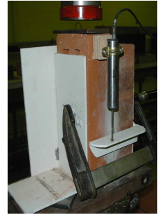
Figure 2. Essai de cisaillement sur des couplets en briques creuses [10]
