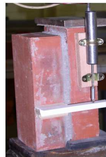
Figure 3. Essai de cisaillement sur des couplets en briques pleine [10]
