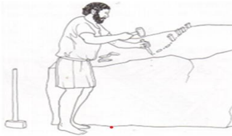
الشكل رقم 3: تقنية اقتلاع الحجارة بشكل عمودي.
